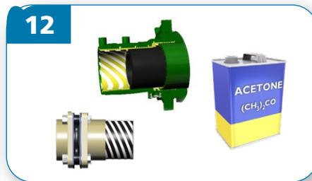
Limpiar el área raspada del accesorio de transición y el interior del accesorio terminal con acetona o isopropanol.
