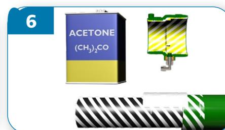
Limpiar las áreas de los tubos que van a soldarse y el interior del accesorio terminal con acetona o isopropanol.
