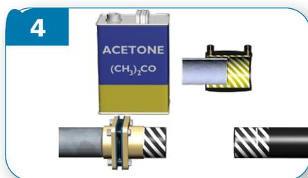
Limpiar el área que va a soldarse del tubo y del accesorio de transición y el interior del manguito de soldadura con acetona o isopropanol.
