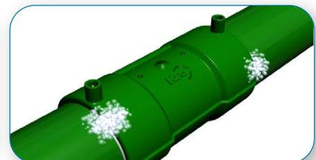
Efectuar una prueba de estanqueidad con agua jabonosa antes del recubrimiento y opcionalmente también durante y después del recubrimiento.
