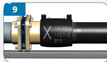
Comprobar que el tubo y el accesorio de transición no se hayan movido durante la soldadura. Comprobar que han salido los indicadores de la soldadura.
