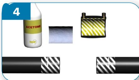
Limpiar el área que va a soldarse de los tubos y el interior del manguito de soldadura con acetona o isopropanol.
