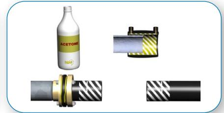
Limpiar las tuberías y el interior de los accesorios inmediatamente antes de la soldadura.
