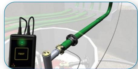
Al usar tubos conductivos KPS, realizar todas las pruebas de conductividad pertinentes (antes y después de cada soldadura) y asegurarse de que el sistema está correctamente conectado a tierra.
