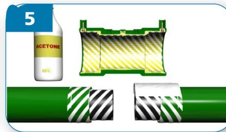
5 Limpiar el área de los tubos/codos/tes que van a ser soldados y el interior del manguito de soldadura con acetona o isopropanol.
