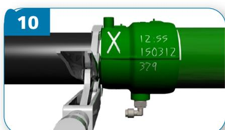
Marcar el manguito de soldadura con una "X", la fecha, la hora y el número de licencia de instalador KPS.
