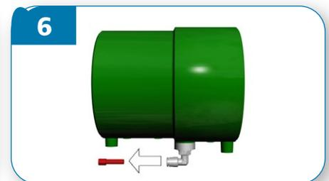
6 Como precaución, abrir el terminal de prueba del accesorio terminal KP T para evitar que el aire caliente forme presión en el espacio intersticial durante la soldadura.
