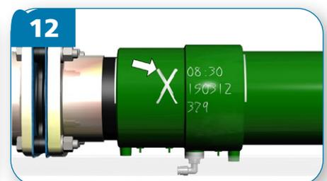
12 Marcar el manguito de soldadura con una "X", la fecha, la hora y el número de licencia de instalador KPS.
