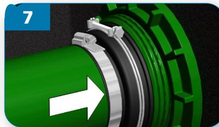
7 Pasar la tubería a través del pasamuros y de la abrazadera, y efectuar las conexiones necesarias dentro de la arqueta.
