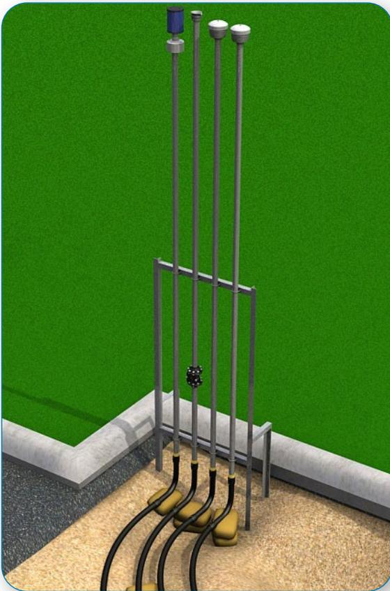
El conducto de ventilación ha de instalarse en la posición correcta y ha de estar asegurado antes de iniciar la instalación de la tubería. Los tubos de ventilación necesitan un apoyo adecuado para que no vuelquen.
