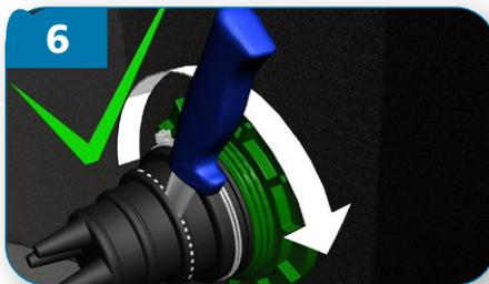
6 Cortar el pasamuros de goma para que encaje en la tubería. Lubricar la tubería si es necesario.
